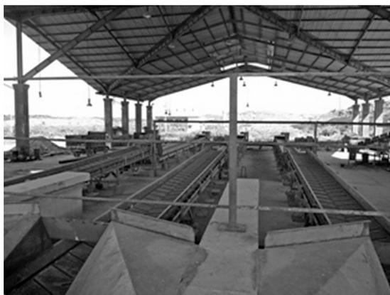
Figure 11 放置されている分別用のベルトコンベアー<sup>16)</sup>
